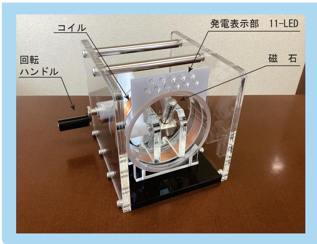
■ ハンドルを回すと磁石が高速回転して発電します。
