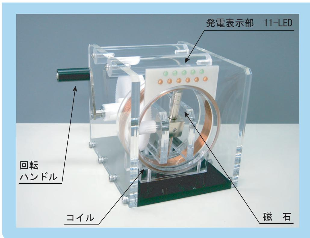
■ ハンドルを回すと磁石が回転して発電します。
