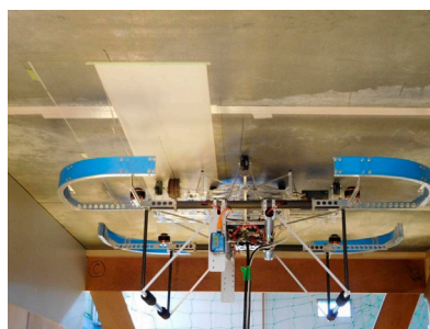
スミ打ち作業ドローン
