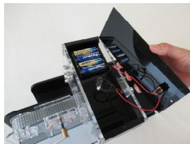
電池交換の様子
