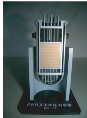
制御棒案内管・上部炉心支持板・ 上部炉心板を載せる
